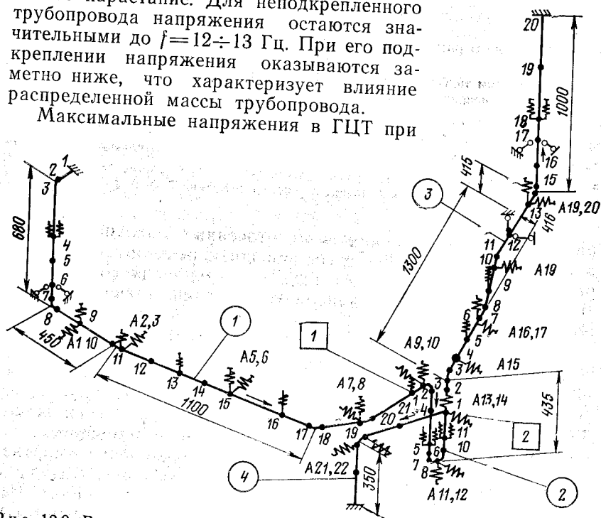
Рис. 12.8. Расчетная схема питательного трубопровода АЭС с водо-водяным реактором:
